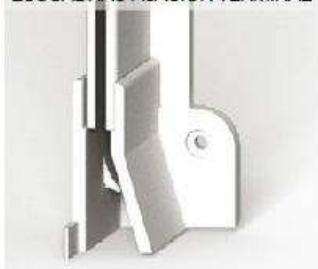
DETALLE ESCUADRAS FIJACIÓN TERMINAL
